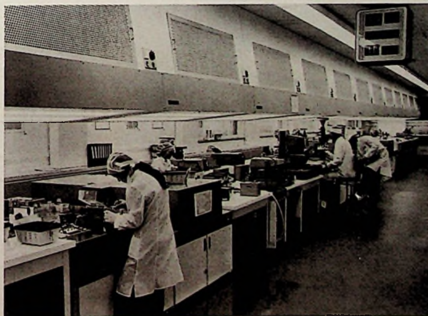
Bild 2. Über diesen fototechnisch arbeitenden Masklertischen sind spezielle Lamina-boxen als Luftzuführung angeordnet, die durch latenten Überdruck besondere Sauberkeit garantieren
