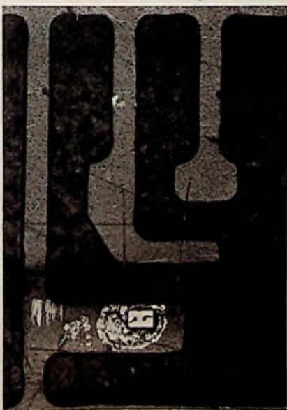
Bild 3. Chip des neuen HF-Transistors BF 506 (SGS-Ates)
